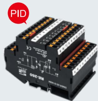
町洋光继电器结构设计紧凑，厚度仅 6.2mm，采用直插式 PID 弹片夹线，节约布线时间，双层设计节省装配空间，在局限的空间中使用预置或单芯线即可免工具直插接线，按压橘色按钮即可轻松退线。产品上的标识牌及可印字壳体提供使用者明确的接线指示，配线准确可靠，可支援讯号传输、隔离、调整或放大。
