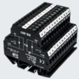
轻薄型光继电器厚度仅6.1mm，适用于空间有限的控制配盘。传统螺丝式夹线结构提供更安全紧固的电线连接且无需维护，是最有效率的配线方式。町洋光继电器规格包含最高10KHz最大开关频率，适用于各种工业等级接口应用。
